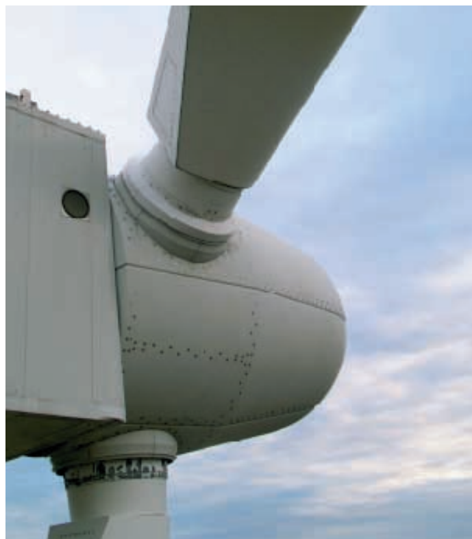
Rotorkopf einer 1,2 MW Windenergieanlage. In denen der geplanten Offshore Windenergieanlagen mit einer Nennleistung von 5 MW werden theoretisch zwei Busse Platz finden.
